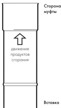
**4.** Перед монтажом края элементов проверить на загрязнения и повреждения. Слегка деформированные горизонтально трубы - не проблема, их можно выровнять при монтаже. Но ни в коем случае элемент не может использоваться, если он деформирован вертикально.
