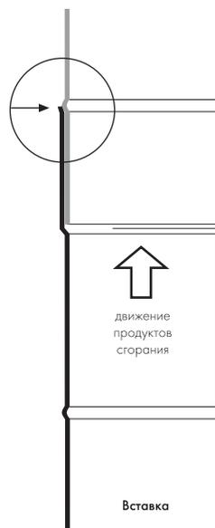
**5.** Каждый элемент соединяется отдельно; элементы трубы стыкуются правильно, если начало муфты насаживается на конус.
