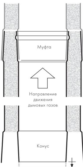
**2.** Важно: Муфта внутренней трубы должна показывать направление выхода отходящих газов!
