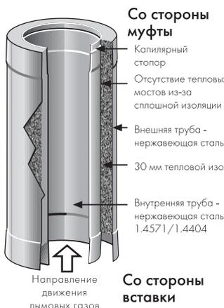
**1.** Перед монтажом элементов проверьте, нет ли загрязнений и деформаций на муфте и конусе! Слегка деформированные горизонтально трубы - это не проблема. Элементы запрещается монтировать при вертикальной деформации.
